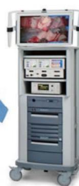
ダ・ヴィンチサージカルシステムの外観を示しています。ダ・ヴィンチシステムは、ロボットの操作台である術者コンソール、ロボット本体であるサージカルカート、およびビジョンカートから構成されます。
